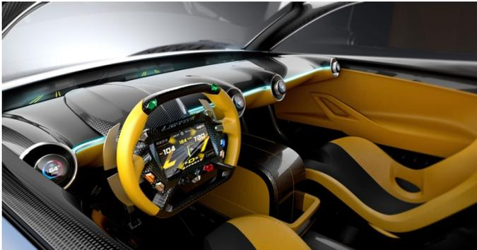
Sopra la plancia una palpebra sotto parabrezza integra 3 display che danno la visione posteriore e laterale della macchina. Gli specchietti retrovisori anche in questo caso sono stati sostituiti dalle telecamere.
